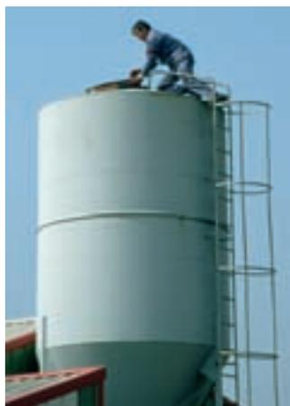
Au-delà de 3 m de hauteur (et d'usage à 2,5 m) les échelles fixes doivent être munies de **crinolines**, ensemble d'arceaux horizontaux et de montants verticaux solidaires de l'échelle.
