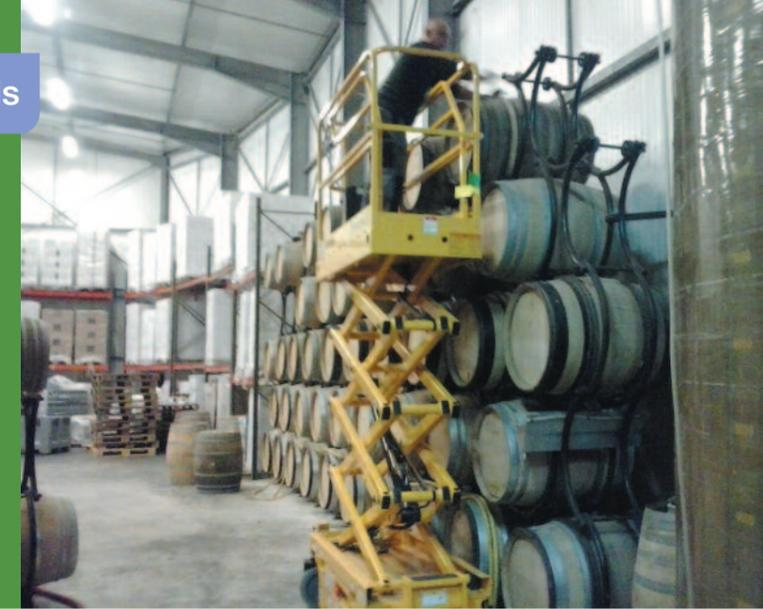
Une plate-forme élévatrice mobile de personnes (**PEMP**) est constituée au minimum d'une plate-forme de travail (nacelle), d'une structure extensible (ciseaux – bras articulés – bras télescopiques...) et d'un châssis porteur. En l'absence d'installation permanente pour travailler en hauteur, les PEMP, appelées également nacelles élévatrices, offrent une solution temporaire d'intervention pour une ou plusieurs personnes selon leur conception.
