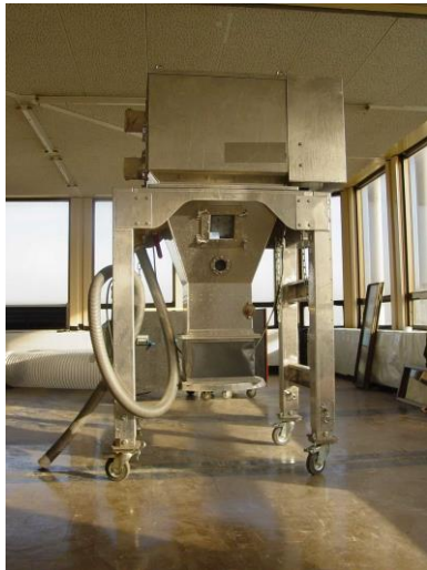
Mécanisme aspirant sous l'entonnoir
